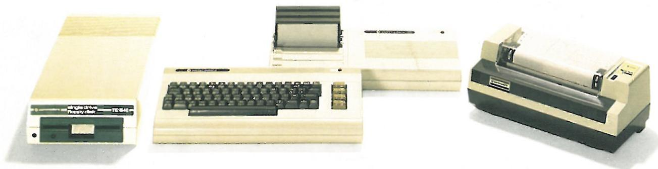
VC 20 – ausbaufähig zu einem ganzen System (Abbildung: Floppy Disk, VC 20 Zentraleinheit, Modulbox, Matrix-Mini-Printer)
