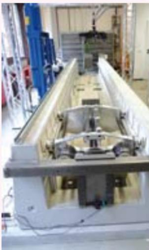
Die Maschinenbau-Lehrstühle öffnen ihre Labore. Es werden spannende Forschungsarbeiten der Lehrstühle präsentiert. Gezeigt wird beispielsweise wie auf einem Crashprüfstand das Verhalten eines Karosseriebauteils im Crashfall untersucht werden kann. Hierzu wird ein Schlitten mit einer Geschwindigkeit von bis zu 80 km/h gegen das Bauteil gefahren.
